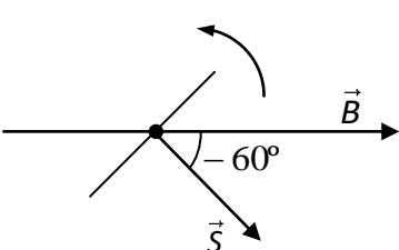
El flujo a través de cada espira del rotor es  $\Phi = BS \cos(\omega t + \varphi)$  y la fem inducida en las 100 espiras del rotor viene dada por,
