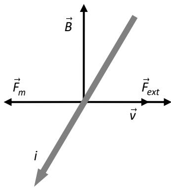
La fuerza magnética ejercida sobre el conductor móvil tiene la dirección de la velocidad y sentido opuesto, como se deduce al aplicar la regla de la mano derecha al producto vectorial anterior (ver figura). Por lo tanto, para que el conductor siga con su movimiento uniforme es necesario aplicar una fuerza externa igual y opuesta a  $F_m$ , es decir
